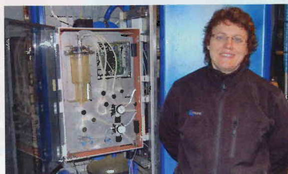
Annette Lind dyrker selv mælkeprøverne, når der er alarm for mastitis. Hun står ved siden af skabet, hvor mælkeprøverne udtages. I beholderen frasorteres syv deciliter mælk, som blandes, hvorefter 50 milliliter sendes videre til analyse.
